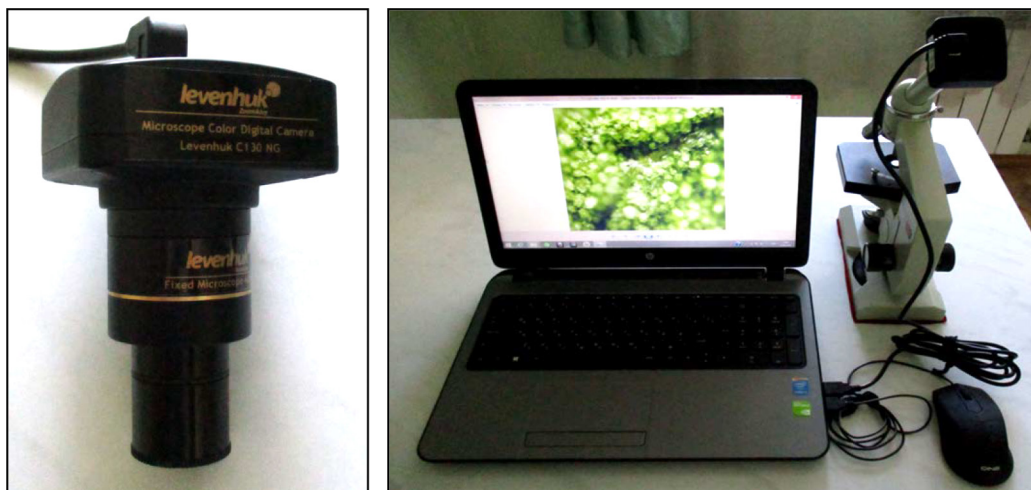
Рис. 6. Внешний вид цифровой видекамеры Levenhuk и персонального компьютера в стадии получения и обработки микроскопического видеоматериала
